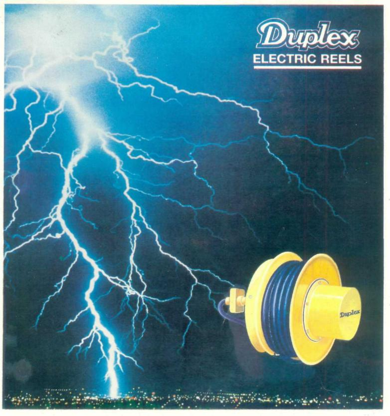
DUPLEX MAKE CABLE REELING DRUMS ARE SPRING POWERED. THE AUTOMATIC REWIND ENABLES EASILY TO SUPPLY THE POWER TO THE MOVING MACHINERY I.E. @ E.O.T. CRANES. ELECTRIC HOIST ETC.THE DRUMS REVOLVES ON A PAIR OF BALL BEARINGS AND THE REEL IS ALMOST MAINTANANCE FREE.
