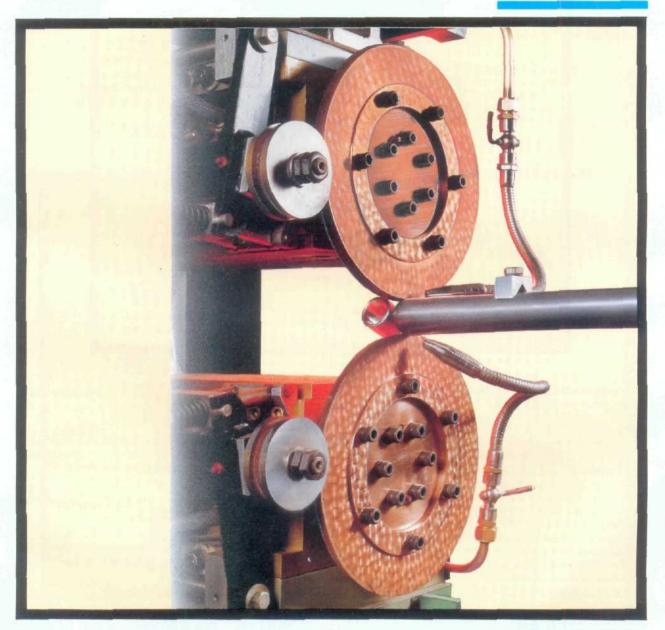
SEAM WELDING MACHINE LONGITUDINAL/CIRCUMFERENTIAL
